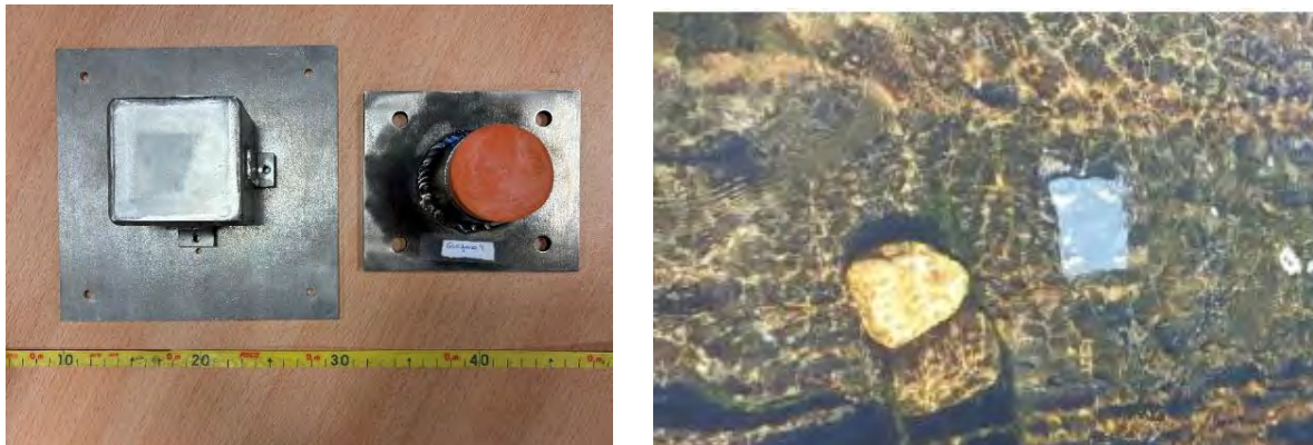
Figura 17. A la izquierda aspecto de las placas de impacto utilizadas en el proyecto y a la derecha imagen de una de ellas bajo el agua.
