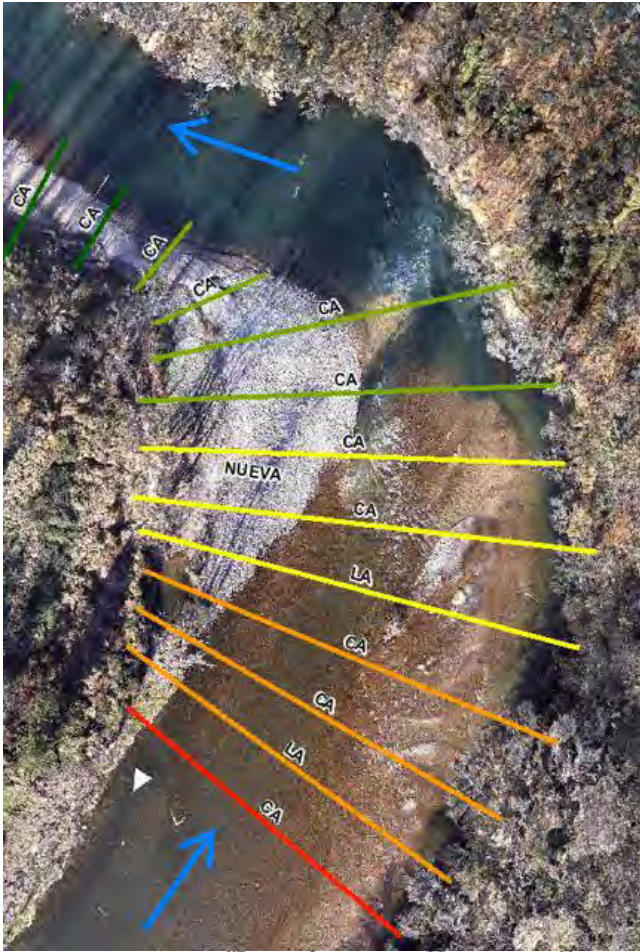
Figura 18. Perfiles de distribución de trazadores RFID, desde tamaños de clasto mayores en los perfiles aguas arriba desde 128, 90 de eje b (colores rojos y naranjas) hacia los más pequeños de 64, 45 y 32 mm (amarillos y verdes). Las flechas indican la dirección de la corriente.
